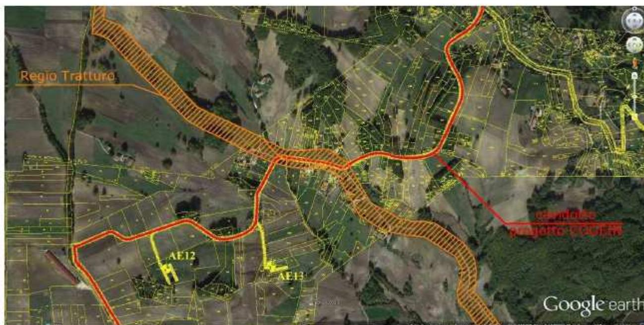
È evidente come, nell'area antistante gli aerogeneratori AE12 e AE13, il cavidotto non solo non rispetti le distanze così come dichiarato nella relazione di progetto, **ma addirittura attraversi nettamente il Regio Tratturo e per un tratto di circa 252 metri.**
